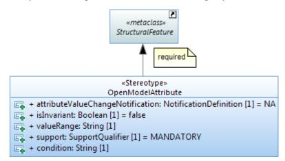
Figure 5.7: «OpenModelAttribute» Stereotype
